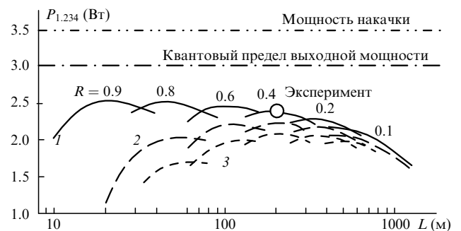
Рис.4. Расчетные зависимости выходной мощности ВКР-лазера от длины фосфосиликатного световода при разных коэффициентах отражения R выходной БР. Мощность накачки P_{1.06} = 3.5 Вт, сосредоточенные потери в резонаторе составляют 0 (1), 0.05 (2) и 0.1 дБ (3).
